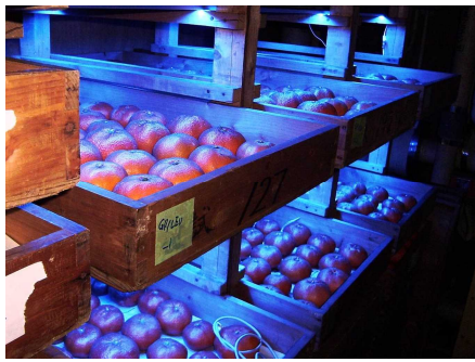
図4 浅型木箱での青色LED光照射試験の様子(左)と腐敗軽減効果(右)
