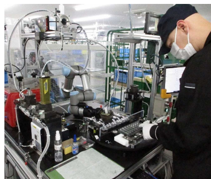
協働ロボットを用いた製造の様子
