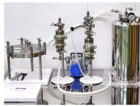
③ ろ過装置 (加圧濾過装置)
