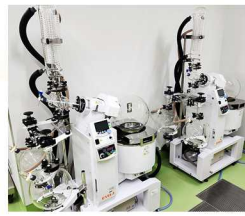
④ 濃縮装置 (エバポレーター)
