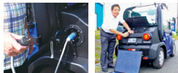
家庭用の100V電源から給電口にコンセントをつなぐだけで充電できる 太陽光パネルから充電でき、停電時の給電機能も備えている
