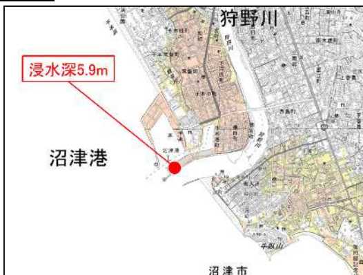
図 6-1 最大浸水深の想定箇所
