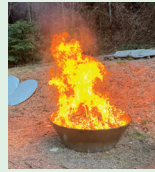
伐採した茶の木でバイオ炭を製造
