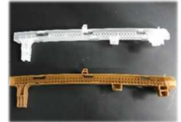
CNF樹脂試作品（窓枠部材） (富士工業技術支援センター)
