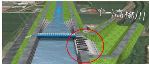
➢ 分流堰の構造検討を進める中で分流部用地の制約から、堰の小規模化を図るため、通常の直線堰よりも越流能力が高いラビンス堰を採用し、越流幅を低減させる構造に変更。
