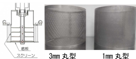
図1 破碎型造粒機 解砕部(左)とスクリーン
