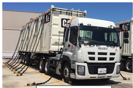
設備の固縛例
