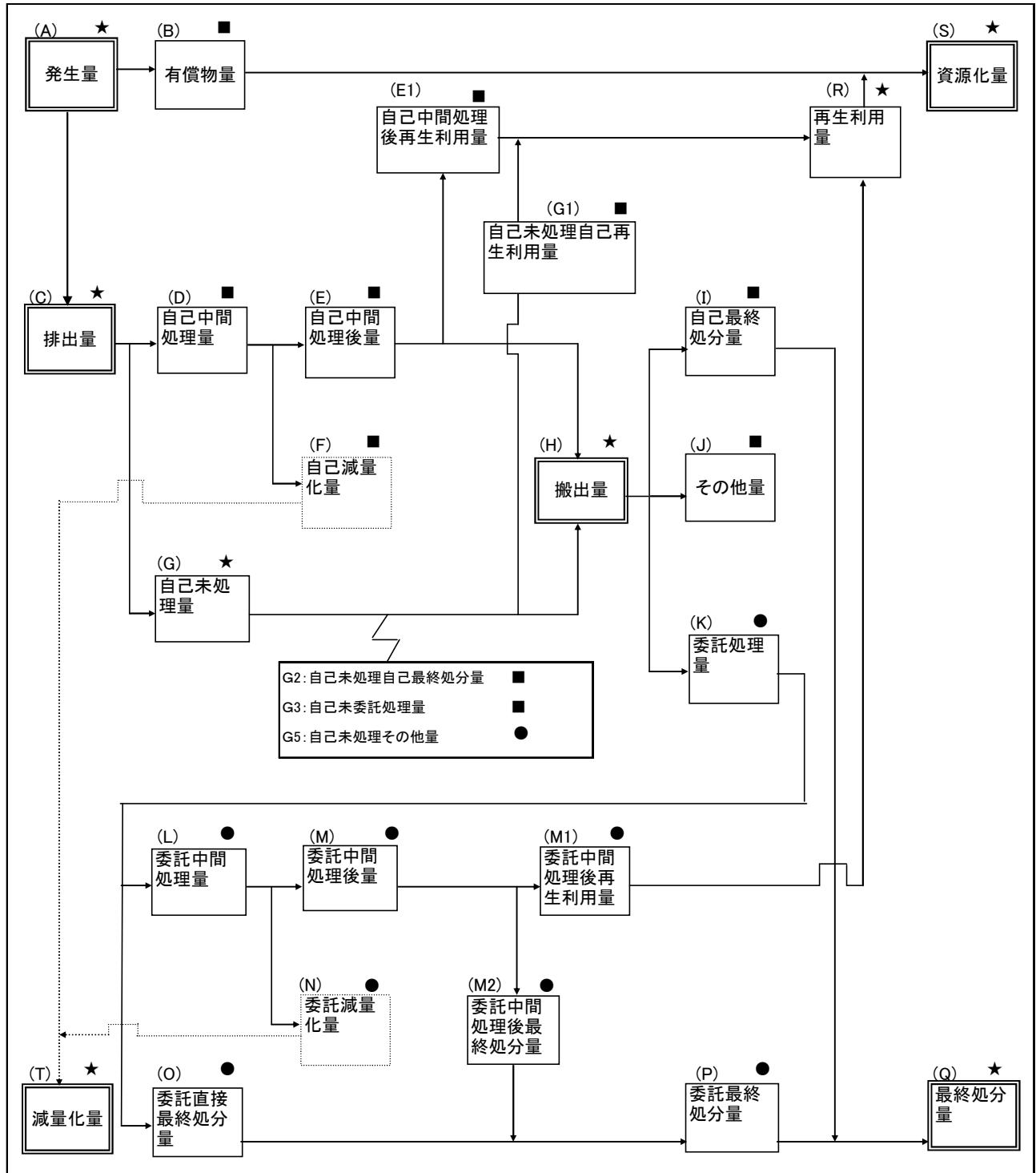
図1 発生量及び処理状況の流れ図
