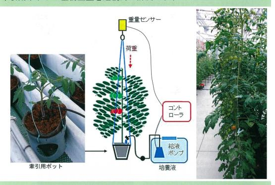
植物の重量を測定して必要なとき必要な分だけ、給液を行います
