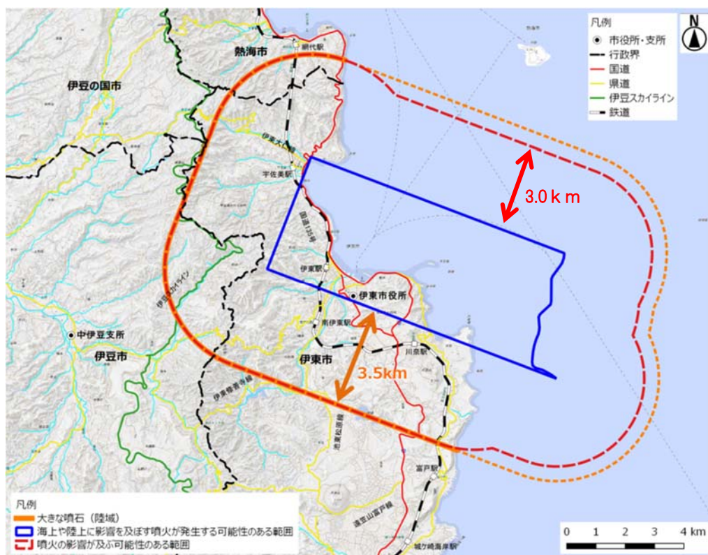
図 2.4.1 大きな噴石の影響範囲（岩塊直径 1.5m（噴出初速度 250m/s）のとき）
