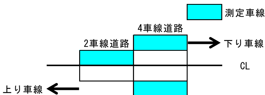
図解-3.2 路面性状調査の測定車線
