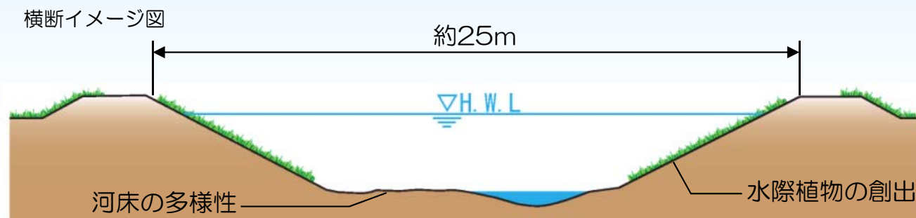
開水路区間（JR東海道線以北）
