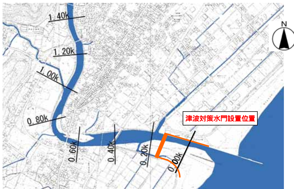
図 4-11 津波対策水門設置位置
