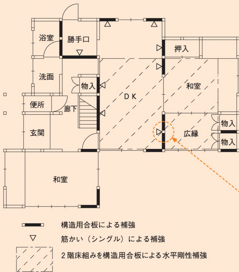
床剛性の確保 2階の床組みを補強することによって、1階に新設した筋かいなどの耐力壁の補強効果が高まります。
