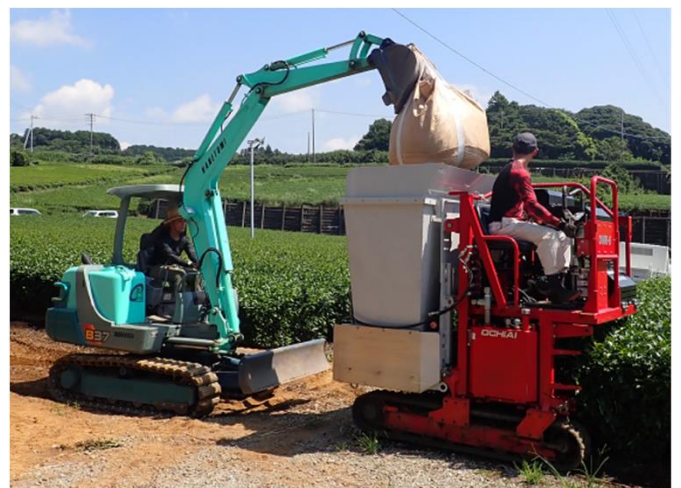
茶園の実証ほにおける牛糞堆肥の機械散布
