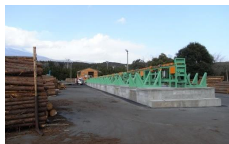
原木市場の再編整備 (富士木材センターに導入された選別機)
