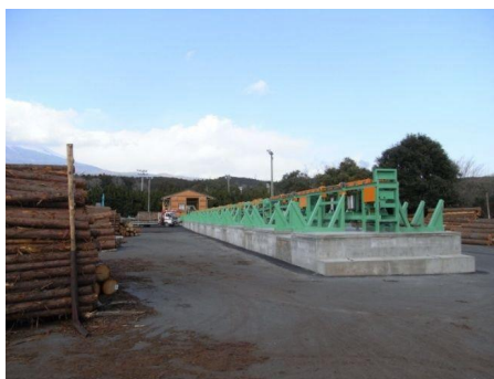
原木市場の再編整備 (富士木材センターに導入された選別機)
