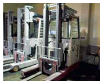
冷凍庫内で使用するフォークリフト
