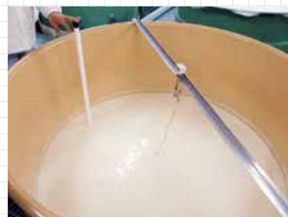
貯蔵タンクはセンサーで温度管理
