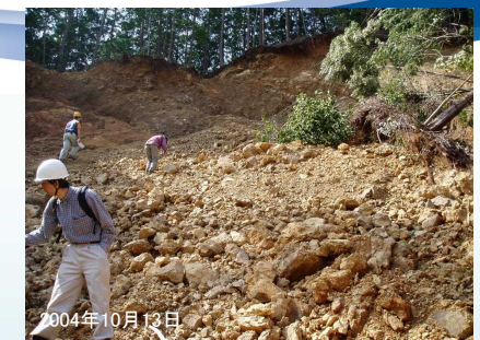
崩壊源頭部の三波川帯泥質片岩、礫径は約5cmが、一部に50cm程度の礫を含む
