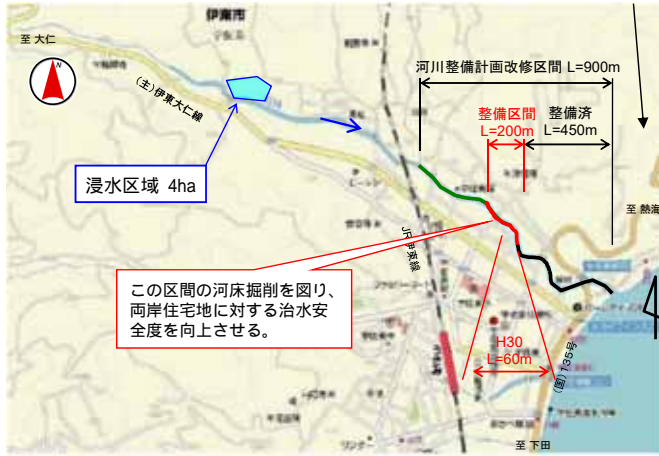
H30年度 根継工、河川断面拡幅 L=60mを実施
