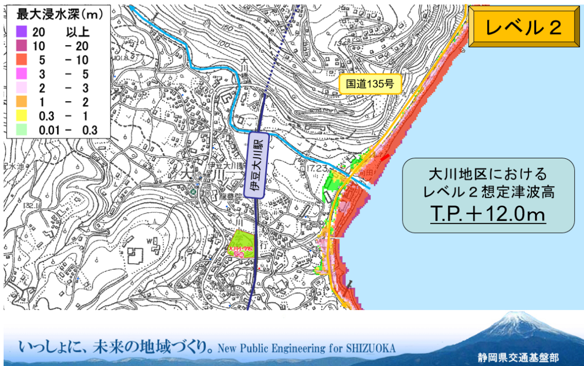
図2 大川地区 相模トラフ沿いの最大クラスの地震（レベル2）最大浸水深図
