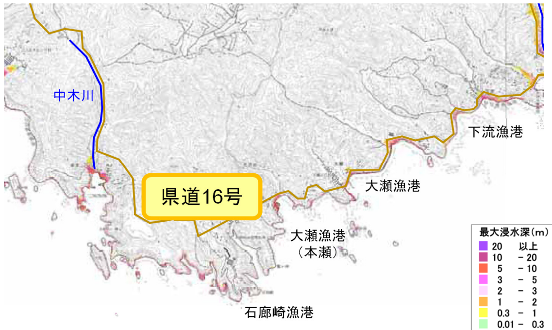
図1 南崎地区 5地震重ね合わせ（レベル1）最大浸水深図
