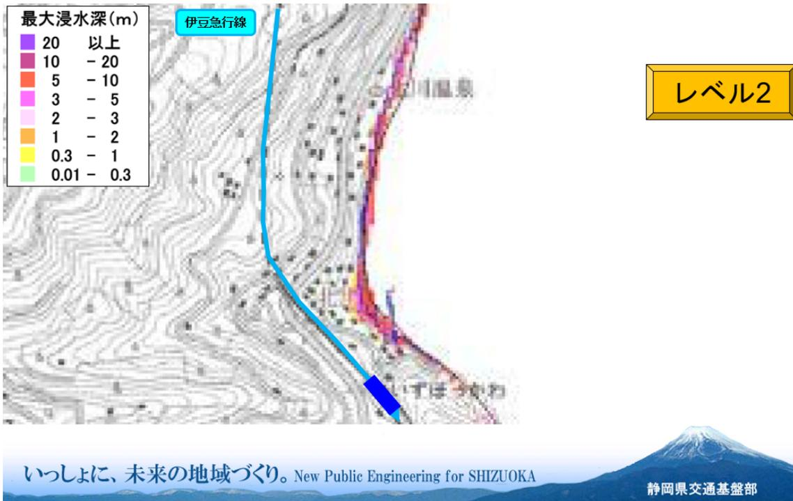
図2 北川地区 相模トラフ沿いの最大クラスの地震（レベル2）最大浸水深図
