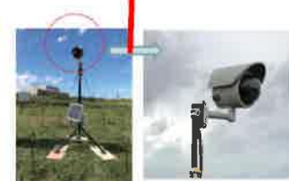
簡易型河川監視カメラの設置
