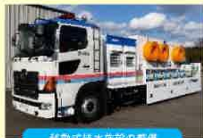
移動式排水施設の整備
