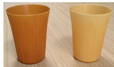
着色材なし、成形条件で褐色の濃度や色ムラをコントロール
