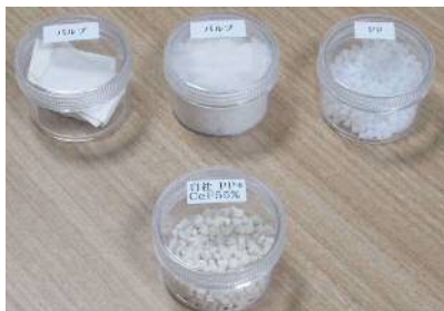
(上)原料:(左・中)パルプ、(右)PP (下)セルローズファイバー55%成形材料
