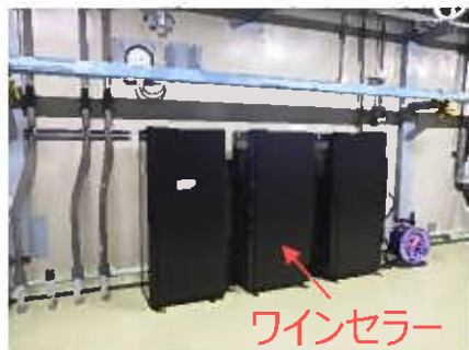
原子核乾板の設置状況 (長期安定化のため冷却)
