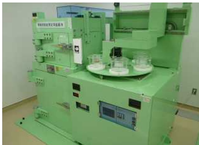
放射能測定装置の例(ゲルマニウム半導体検出器)
