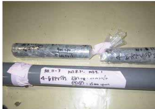
40mm×670mm, 0.6kg 表面線量率：20 \mu Sv/h
