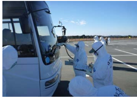
GMサーベイメータによる検査及び簡易除染
