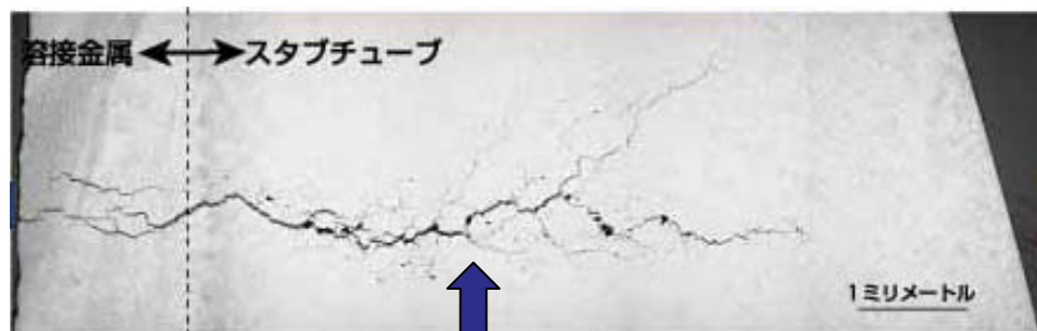
応力腐食割れ
