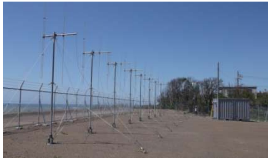
設置したVHFレーダーのアンテナおよび観測所
