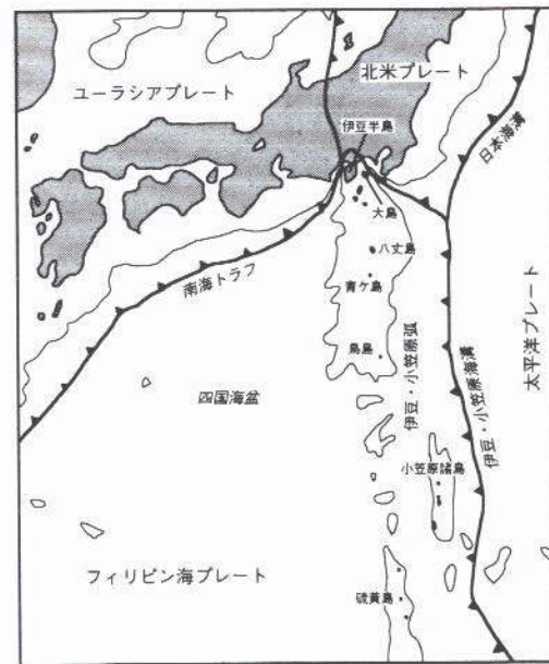
(図2) 日本付近のプレート配置と伊豆・小笠原弧。海岸線のほかに、水深2000mの等深線をあわせて示した。伊豆・小笠原海溝において、太平洋プレートはフィリピン海プレートの下に沈み込んでいる。この沈み込みが原因となって、フィリピン海プレートの東縁には活動的な火山弧である伊豆・小笠原弧が形作られている。伊豆・小笠原弧をのせたフィリピン海プレートは北西に向かって移動しており、南海トラフにおいて日本列島の下に沈み込んでいる。ところが、伊豆・小笠原弧の先端（現在の伊豆半島）は本州の下に沈み込むことができず、本州に衝突してしまった。
