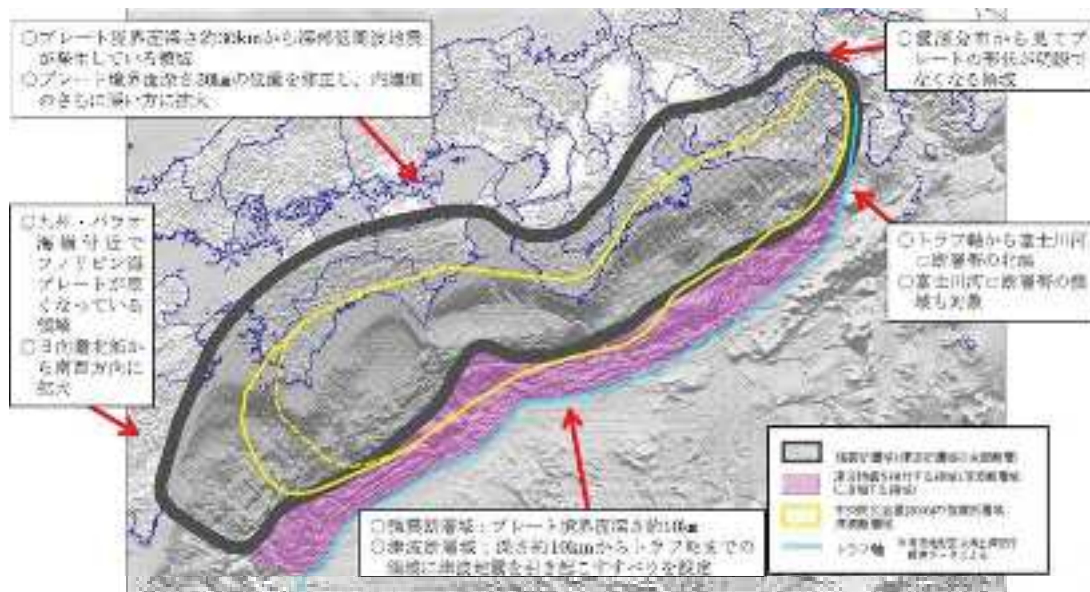
図3 南海トラフで最大クラスの地震の想定震源域
