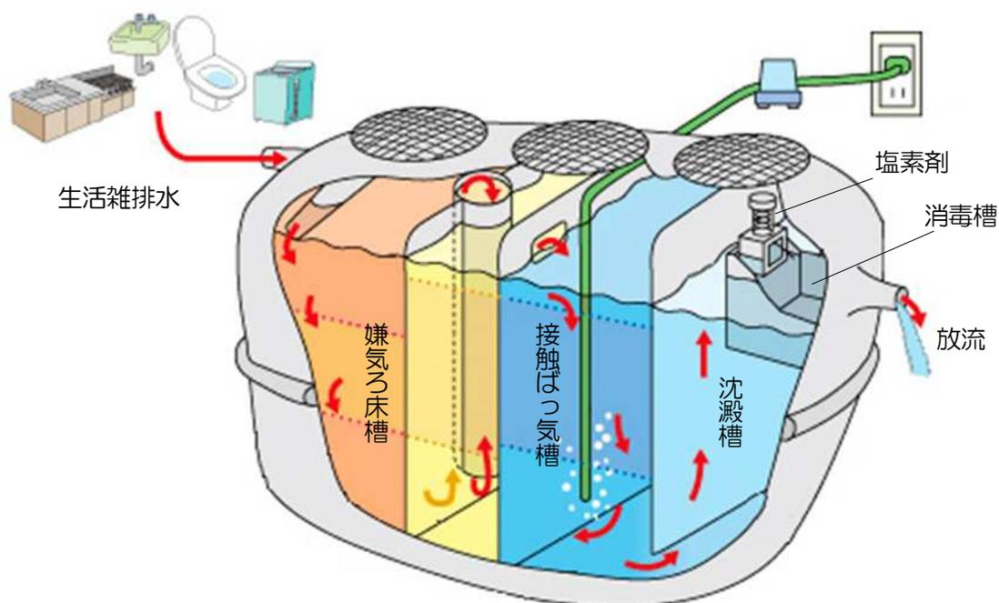
嫌気ろ床槽・・・汚水中の固形物を取り除くとともに、嫌気性微生物が有機物を分解します
