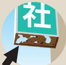
側板底面の腐食、破損
