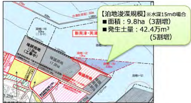
清水港 新興津コンテナターミナル整備計画 (代替案) [-15m/-15m/-12m/-15m]の配置案
