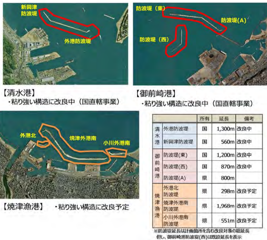
図 6-30 駿河湾港及び焼津漁港のねばり強い構造への防波堤改良計画
