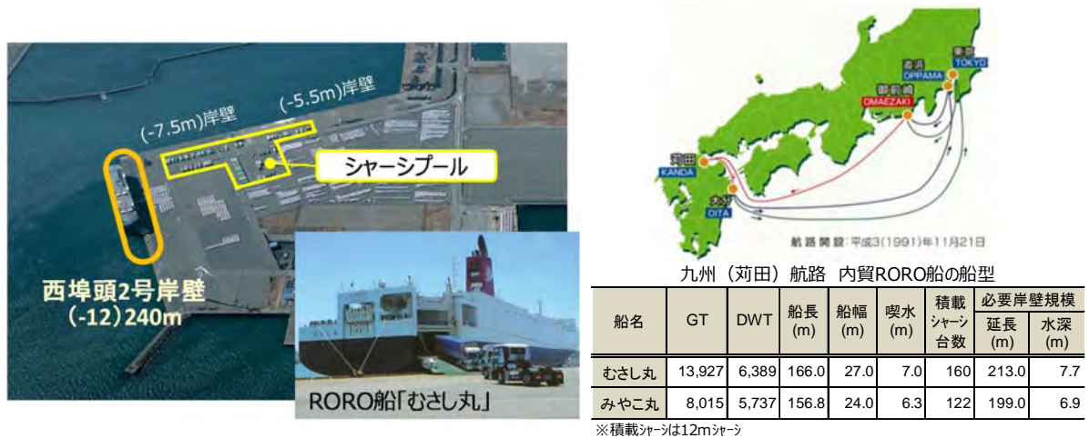
図 3-26 駿河湾港の内貿 RORO ターミナルの整備状況
