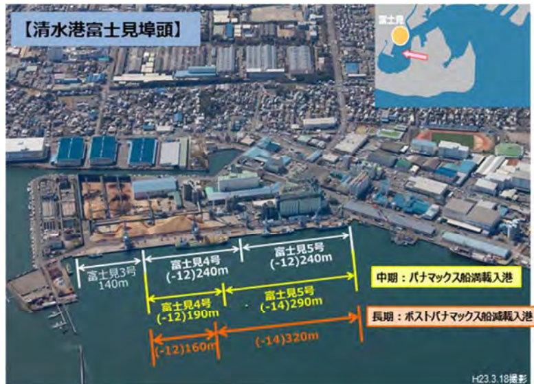
図 6-9 清水港富士見埠頭の穀物船対応岸壁整備計画（既定計画）
