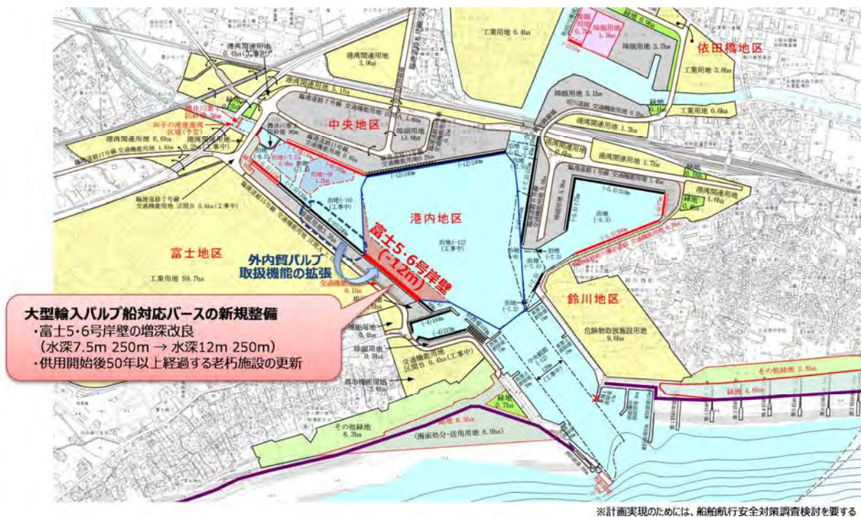
図 3-11 田子の浦港の輸入パルプ船対応ターミナルの整備イメージ
