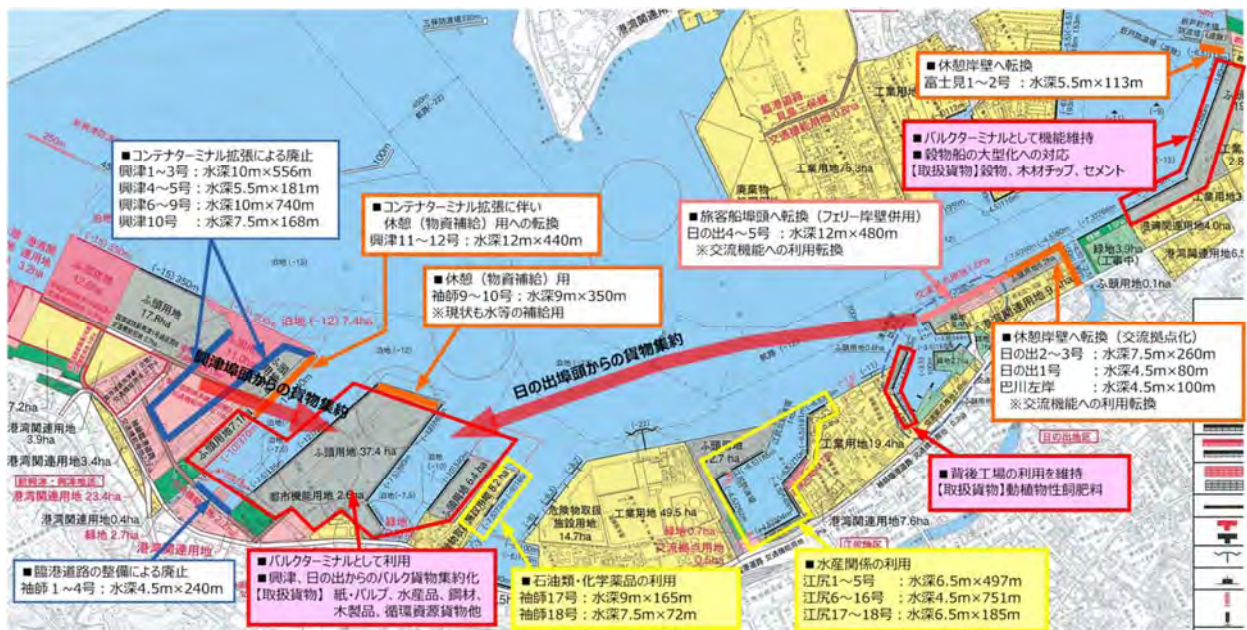
図 5-9 清水港におけるバルク岸壁の利用転換・廃止計画
