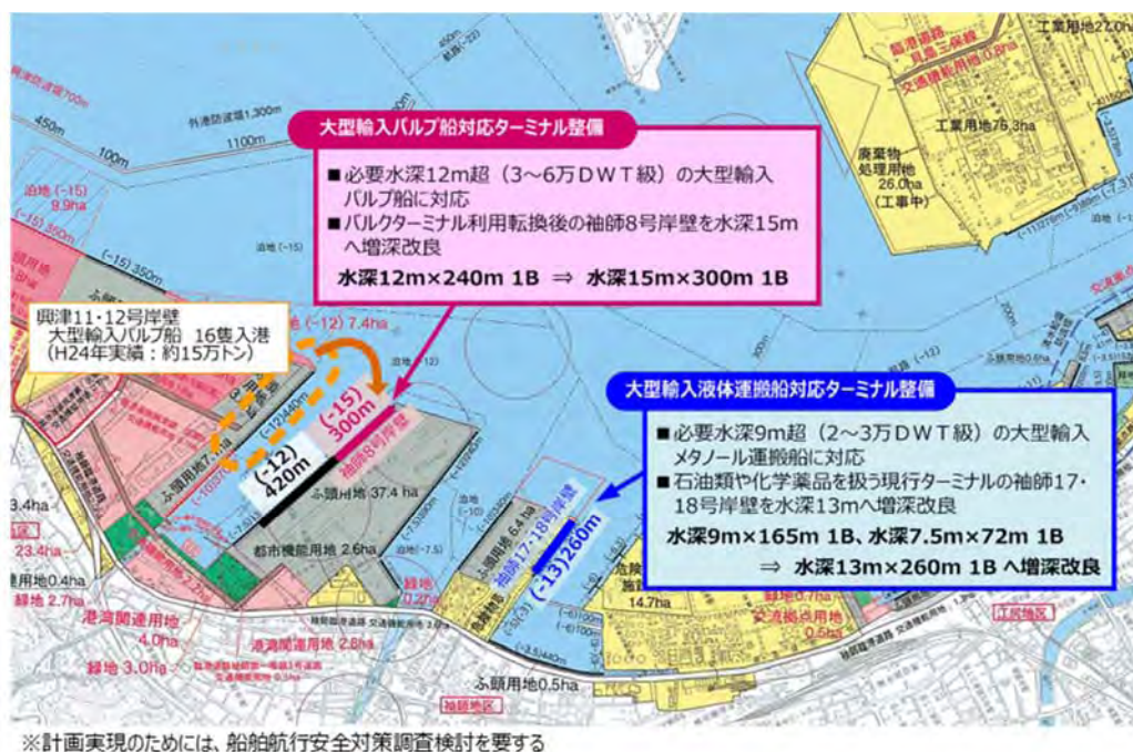
図 5-13 清水港袖師第1・第2埠頭の大形外貿バルク船対応岸壁整備計画
