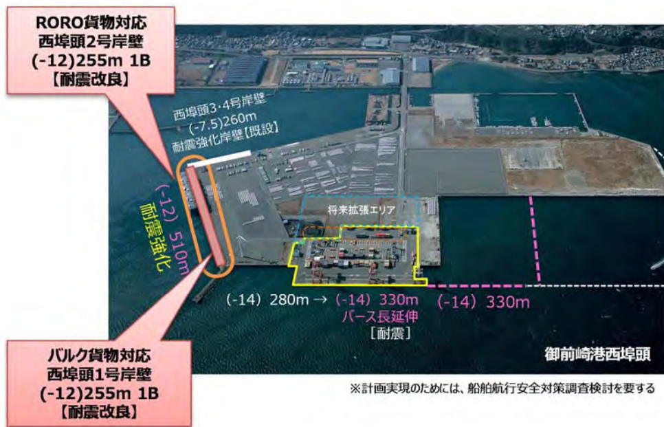
図 5-26 御前崎港 RORO・バルク対応耐震強化岸壁の整備計画図
