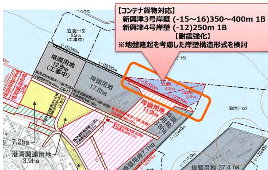
図 5-24 清水港コンテナ対応耐震強化岸壁の整備計画図
