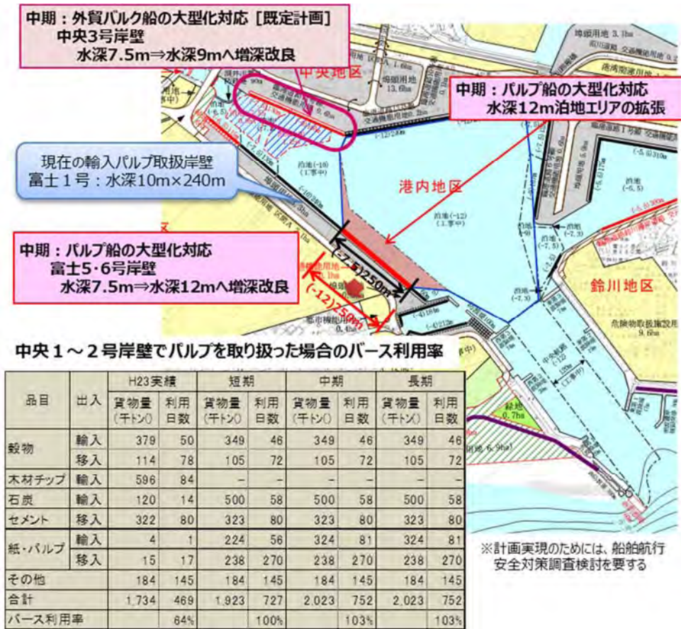
図 5-14 田子の浦港富士埠頭のバルブ船等対応岸壁整備計画
