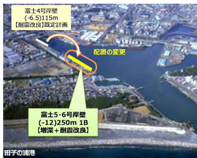
図 5-22 田子の浦港における緊急物資等輸送用耐震強化岸壁の配置変更計画
