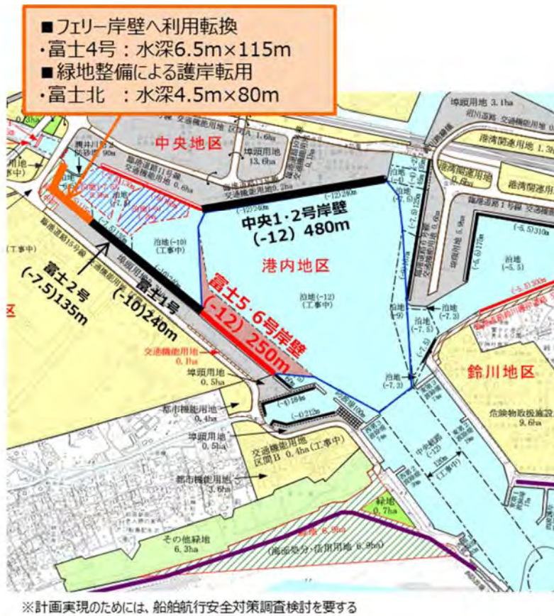
図 5-10 田子の浦港におけるバルク岸壁の利用転換・廃止計画
