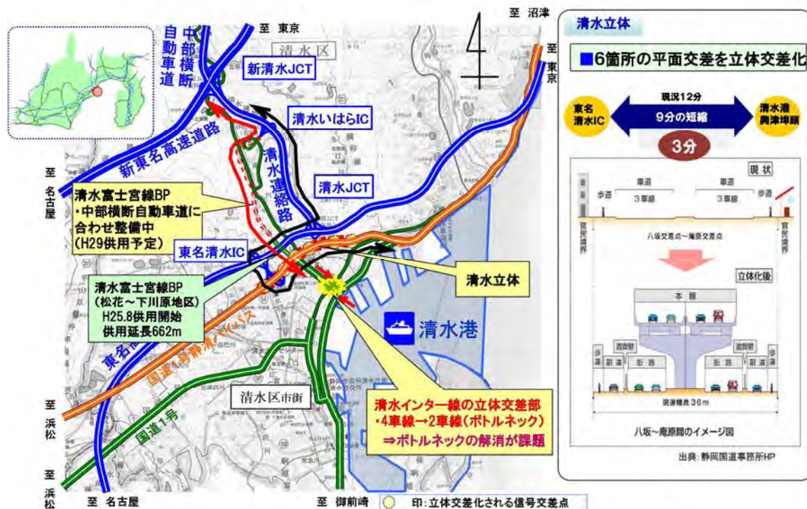
図 1-36 清水港における臨港交通体系の現状とボトルネック箇所
