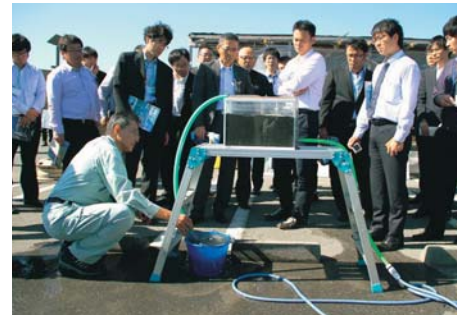
土砂の吸上げを模型にて再現
