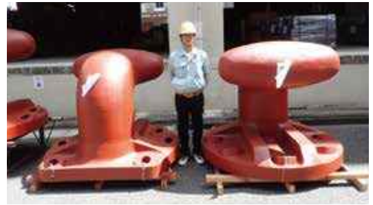
22万GT級の大型クルーズ船に対応した係船柱
