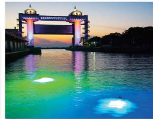
内港での水中照明実験
