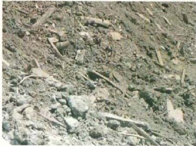
残土の状況。20~30cm程度の木の棒がかなり混入している。
