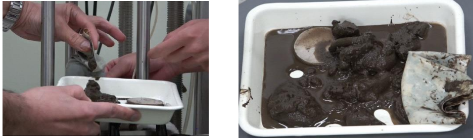
図7 吸水軟化試験後の流動化した状態の供試体（報告書 P7-28）
