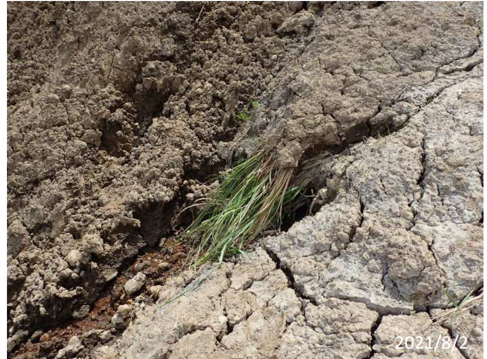
07 湧水地点。崩土と地山の境界で湧出している。(標高370m付近)
