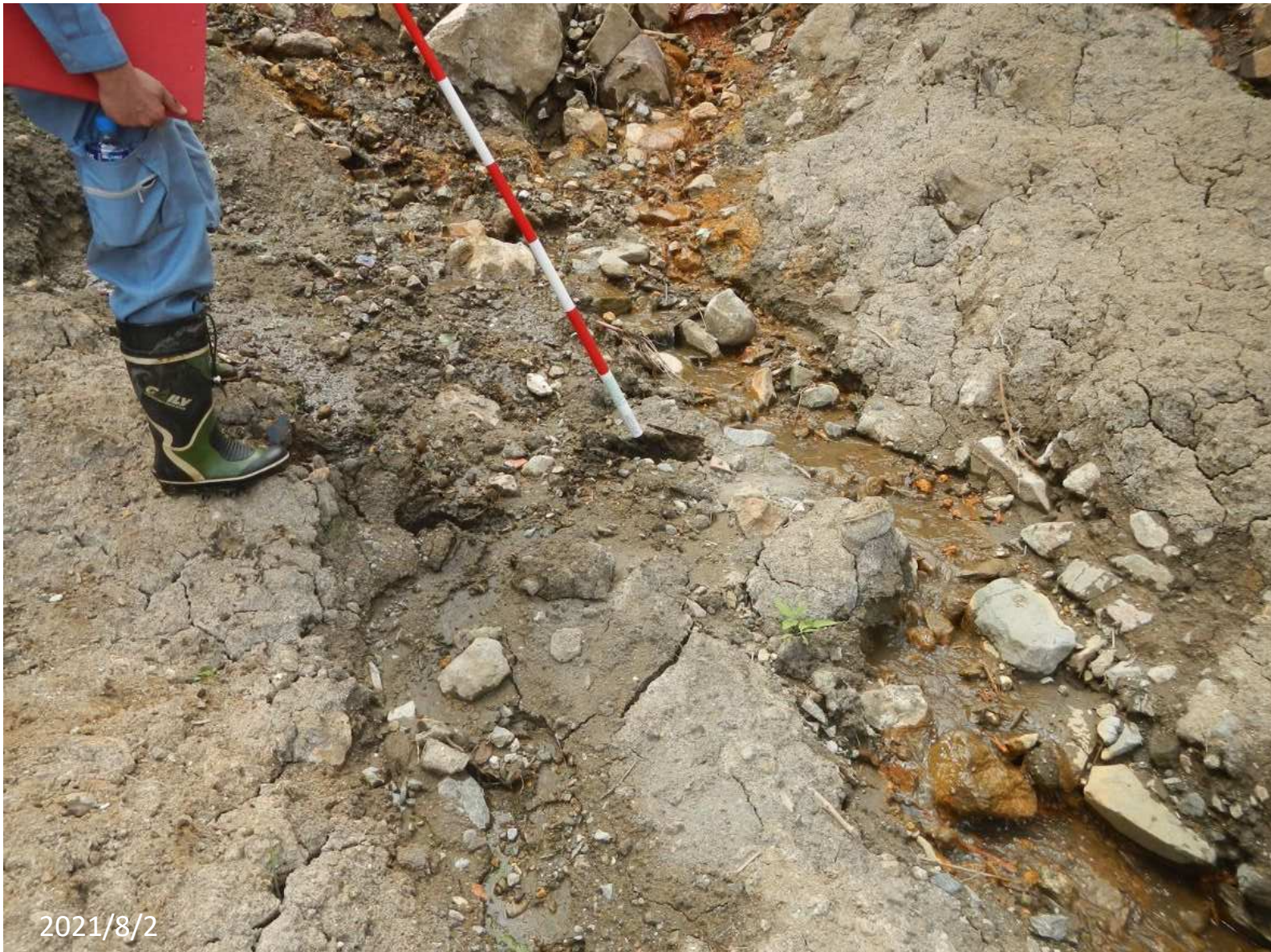
10 崩土の塑性は、含水状態によって塑性が著しく変化する。長靴の位置は乾燥しているため固いのに対し、ポール先の(足がはまった跡)は湿っているため著しく泥濘化している。
