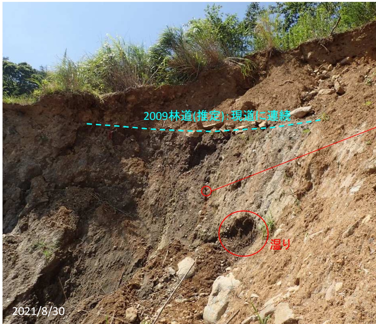
03 右岸側崩壊地の源頭部(写真03番の隣接箇所)。破線より下位の土の内部に、直径2～3cmのパイピングホールや湿り箇所あり。
