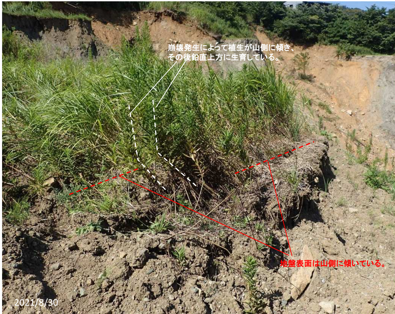
05 落ち残り土塊の表面は山側に傾いていることから、後方回転運動を伴うすべり形態で落下したことが分かる。
