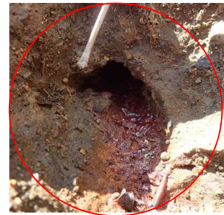
03 右岸側崩壊地の源頭部(写真03番の隣接箇所)。破線より下位の土の内部に、直径2～3cmのパイピングホールや湿り箇所あり。
