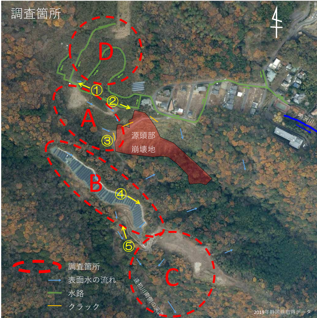
雨水は逢初川ではなく、側溝を通じてその北側の鳴沢川に流入
