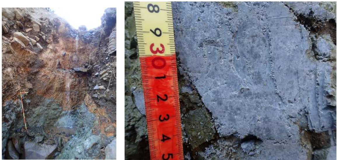
図 7 赤褐色の変質層の下位に露出した、緑白色に変質した層（盛土下端付近の溪床）
